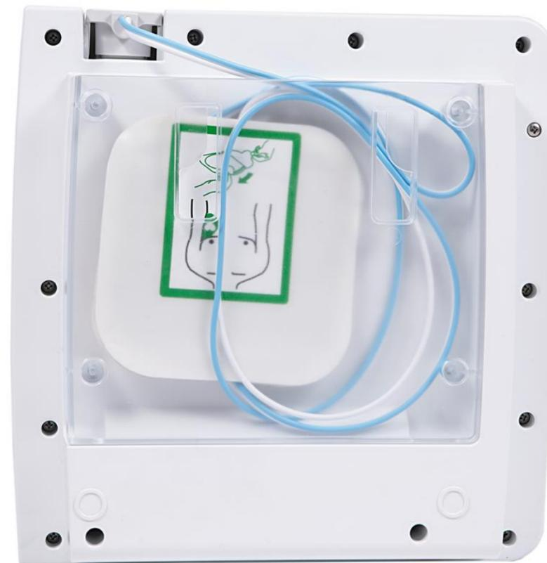
Die versiegelte Verpackung mit den Einwegelektroden wird sicher aufbewahrt, während sich der AED im Standby-Modus befindet und leicht zu prüfen, um die Integrität und Gültigkeit zu verifizieren
